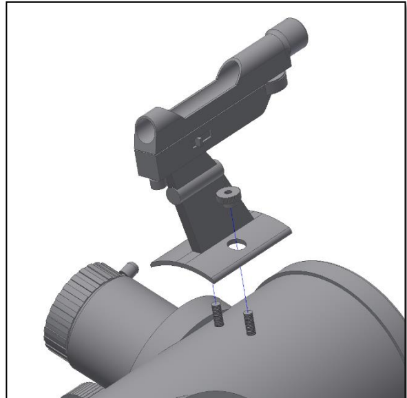
Fig. 11. Asegurar el tubo del buscador con tuercas de mariposa.
