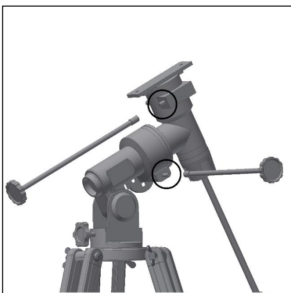
Fig. 6. Colocación de los tornillos de ajuste de precisión.
