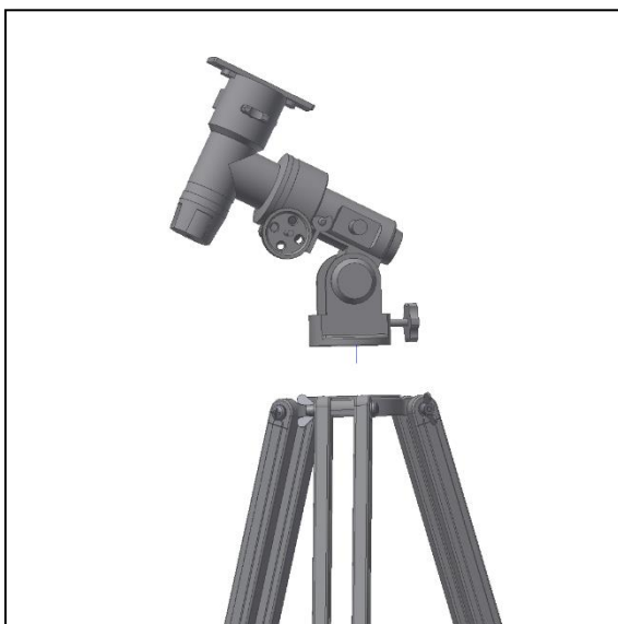
Fig. 4. Montaje de la montura ecuatorial.
