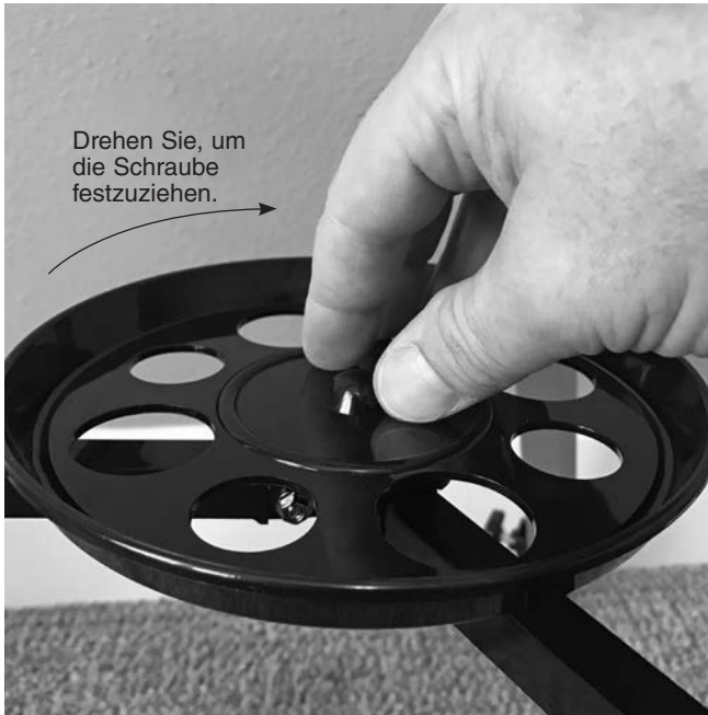
Abbildung 6. Schrauben Sie die Zubehörablage auf die Stativbeinstrebe. Die Schraube an der Unterseite der Ablage wird in die Bohrung in der Mitte der Stütze eingeschraubt.
