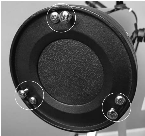
Abbildung 16. Die Neigung des Primärspiegels wird mit den drei Schraubenpaaren am hinteren Ende des Optikrohrs eingestellt.
