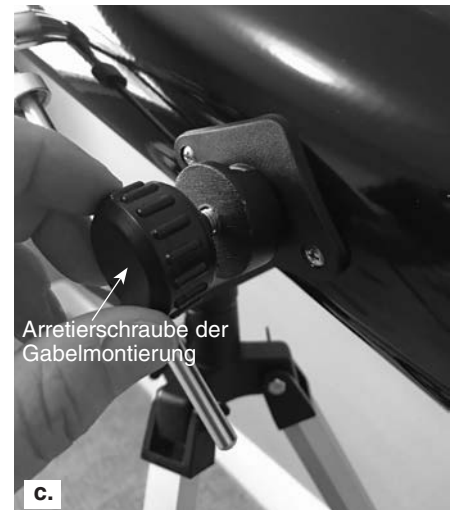
Abbildung 8. Anbringen des Optiktrohrs an der Montierung. a) Schieben Sie die Stange zur Feinjustierung der Höheneinstellung in die entsprechende Bohrung. b) Platzieren Sie die Beschläge der Optiktrohbefestigung in den Nuten der Gabelmontierung. c) Montieren Sie Arretierschrauben der Gabelmontierung.
