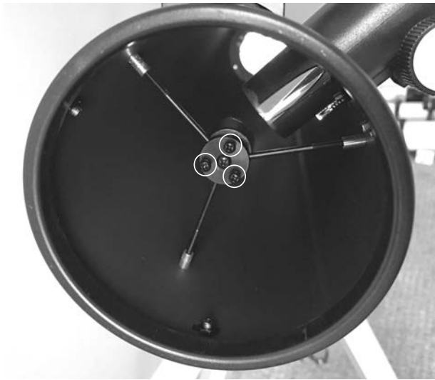
Abbildung 15. Stellen Sie mit einem Kreuzschlitz-Schraubendreher die Neigung des Sekundärspiegels durch Justieren der drei Stellschrauben für die Sekundärspiegeljustierung ein.
