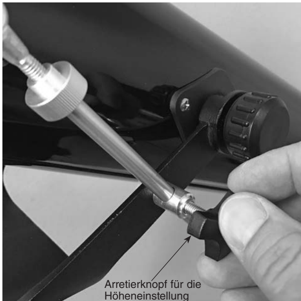
Abbildung 9. Schrauben Sie den Arretierknopf für die Höheneinstellung ein.
