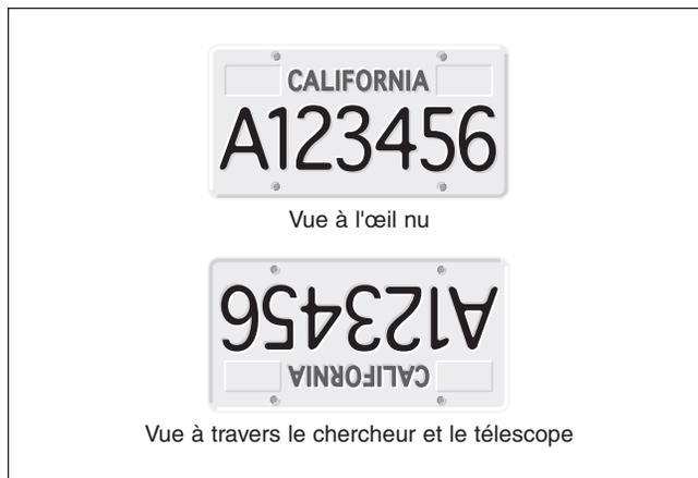
**Figure 40.** La vue à travers le chercheur droit d'un télescope réflecteur est inversée à 180°. C'est également le cas pour le XX12 et son chercheur.
