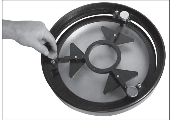
**Figure 36.** L'inclinaison du miroir principal peut être ajustée en tournant un ou plusieurs des trois boutons de collimation.
