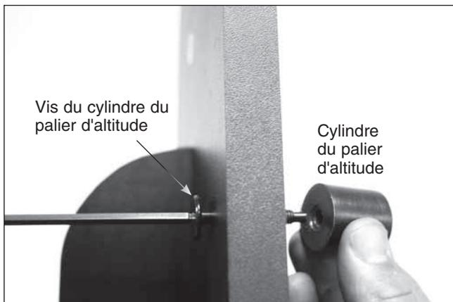
**Figure 9.** Placez un cylindre du palier contre le panneau latéral et serrez la vis du cylindre du palier d'altitude. L'extrémité biseautée du cylindre doit être orientée vers l'extérieur.
