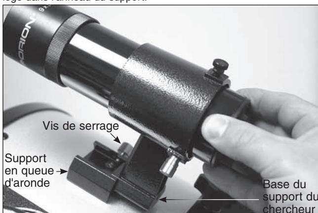
**Figure 28.** La base du support du chercheur se loge dans le support en queue d'aronde où une vis de serrage permet de la fixer.
