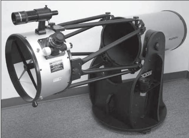
**Figure 32.** Cette image montre le XX12 correctement mis en place pour la collimation. Remarquez le papier blanc placé sous le porte-oculaire et l'angle du tube optique. Idéalement, le télescope doit être pointé sur un mur blanc.
