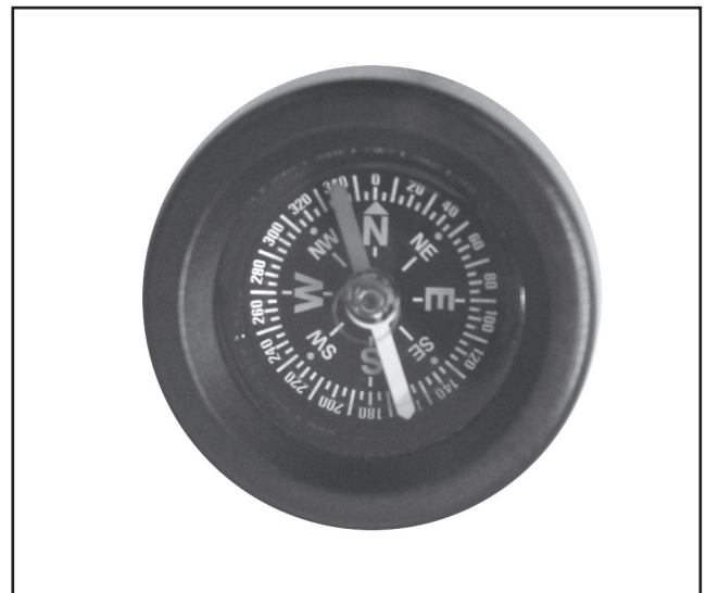
Abbildung O. Kompasspeilung eingestellt auf die magnetische Deklination von Irvine, Kalifornien
