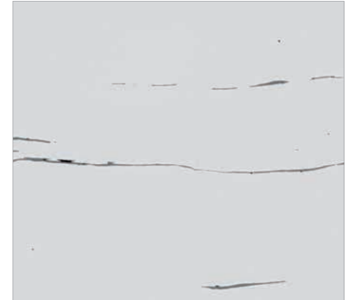
Nicht-metallische Einschlüsse in Stahl Mikroskop: ZEISS Axio Imager.Z2m Objektiv: EC Epiplan-NEOFLUAR 10x/0,25 Kamera: ZEISS AxioCam MRC
