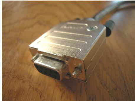
Les deux connecteurs sont câblés point à point (câblage droit), avec un peu de puissance (1A) est transporté sur les pins (1+ 6 ; masse) et 5 (12V). Sur les pins 1+6, on connecte la tresse de blindage, et sur la pin 5, on soude trois fils.
