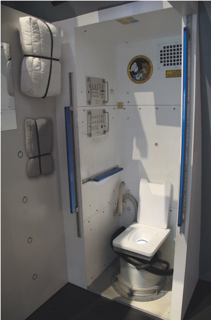
Abb. 2.24 Die Toilette auf der ISS (hier Nachbau im Kennedy Space Center) funktioniert mit Unterdruck. Spitzname: orbital outhouse
