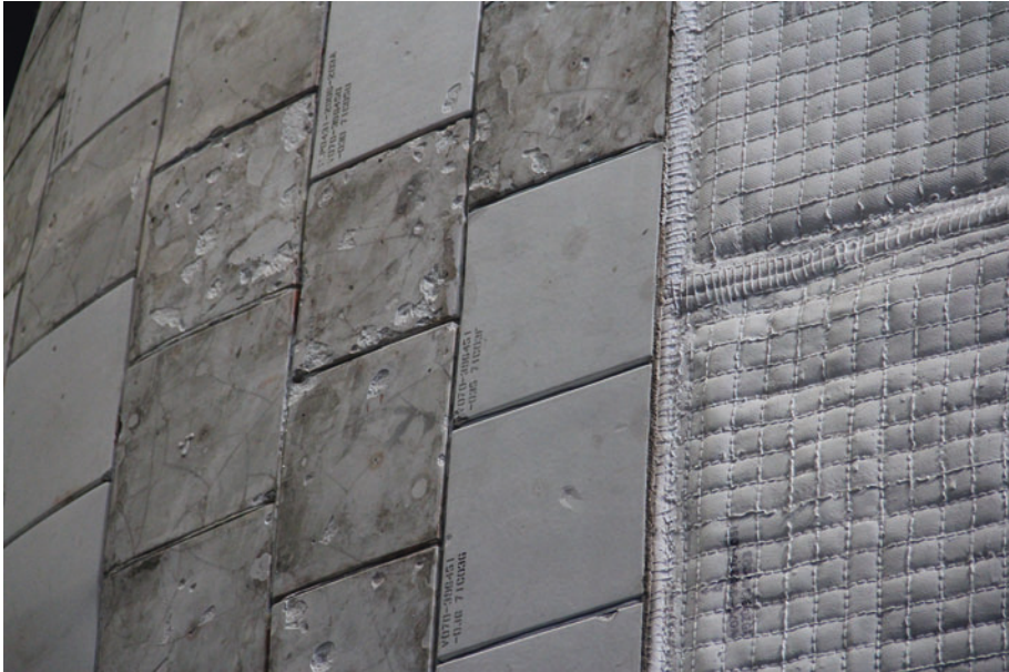
Abb. 2.7 Hitzeschutz auf der Oberseite des Space Shuttles Atlantis. Die stärker aufheizenden Regionen (links) sind mit Hitzeschutzkacheln belegt, die weniger stark aufheizenden (rechts) mit Nomex-Gewebe abgeschirmt
