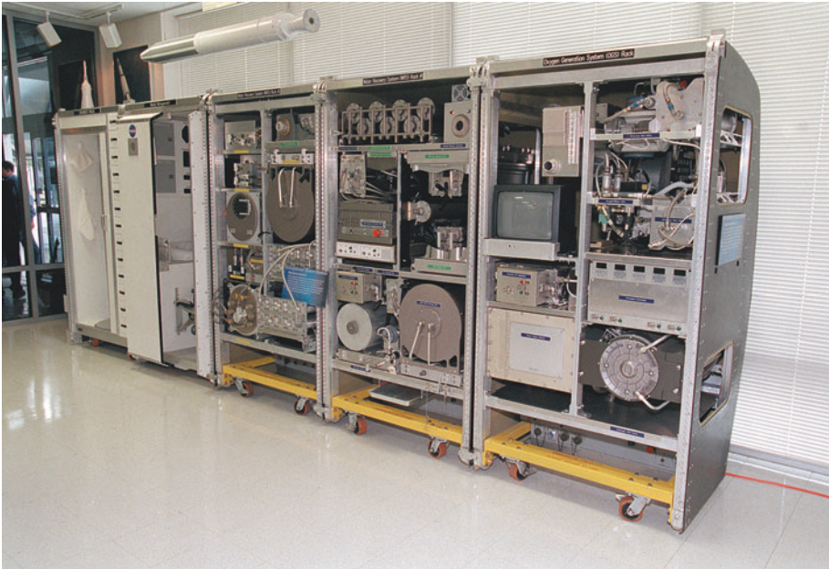
Abb. 2.23 Das Environmental Control and Life Support System (ECLSS), Lebenserhaltungssystem der Internationalen Raumstation. Bestehend aus Sauerstoffversorgung, CO 2 -Entfernung, Luftfilterung und Wasseraufbereitung. (Bildquelle: NASA)
