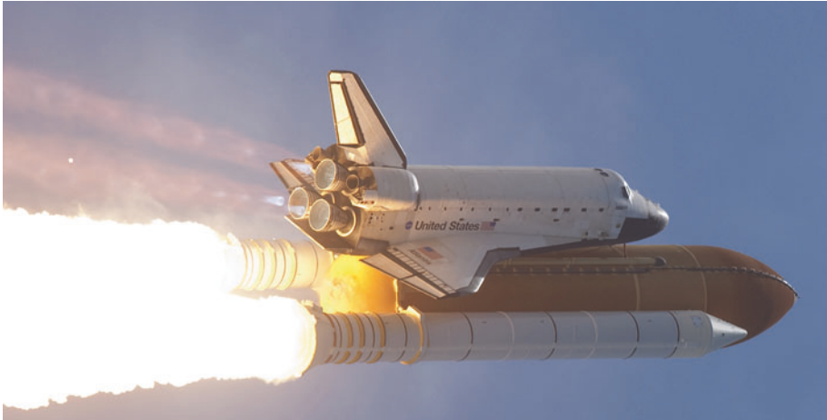
Abb. 2.14 Mach'sche Knoten sind in den Triebwerksstrahlen der wasserstoffbetriebenen Spaceshuttle Haupttriebwerken sichtbar, in denen sich Schallwellen innerhalb des Triebwerksstrahls refokussieren. (Bildquelle: NASA)
