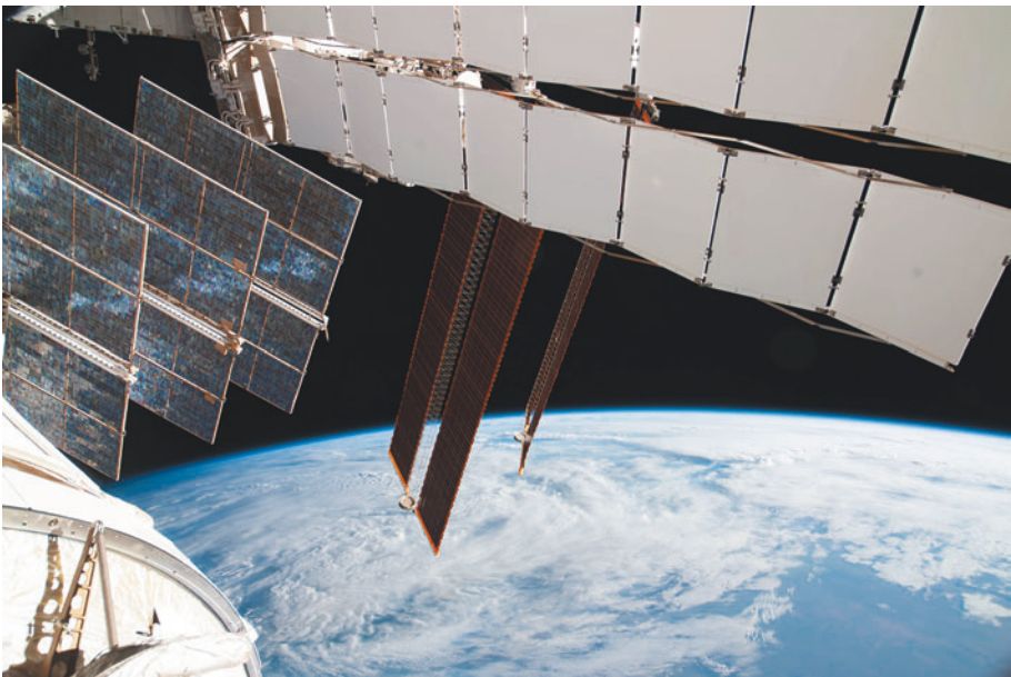
Abb. 2.21 Kühlpaneele (weiß) an der Internationalen Raumstation. Der Ammoniak-Kühlkreislauf der Station fließt durch diese Paneele, die die Wärme in den Weltraum hinaus als Infrarotstrahlung abstrahlen. (Bildquelle: NASA)
