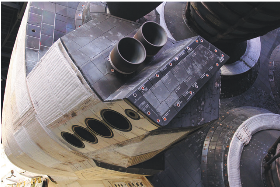
Abb. 2.15 Steuerdüsen, Vernier-Düsen und Hitzeschildkacheln am Heck des Space-shuttles „Atlantis“
