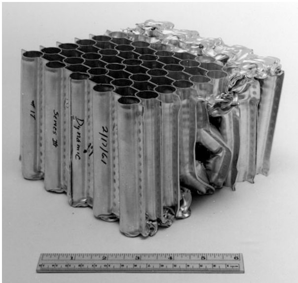
Abb. 2.8 Beispiel für ein Crush-Core-Material, das sich bei Belastung plastisch verformt und somit Bewegungsenergie absorbiert. Dieses Aluminiumbauteil stammt aus dem Lande Bein eines Prototypen einer unbemannten Surveyor-Mondsonde. (Bildquelle: NASA)
