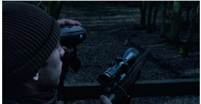
Lo ZEISS DTI 3/25 offre un campo visivo estremamente ampio di 26 metri a una distanza di 100 metri, ideale per la caccia di notte in zone boschive o nell'area di pastura.
