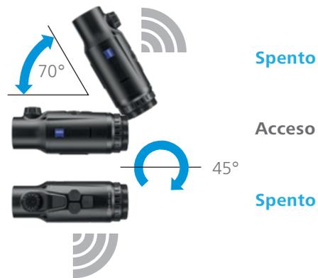
Il sensore angolare rileva automaticamente la posizione esatta dello ZEISS DTC 3 e attiva la modalità di stand-by a un angolo laterale di 45° e a un angolo discendente o ascendente di 70°. Non appena il cacciatore porta l'arma in posizione di sparo, il dispositivo esce automaticamente dalla modalità di stand-by.
